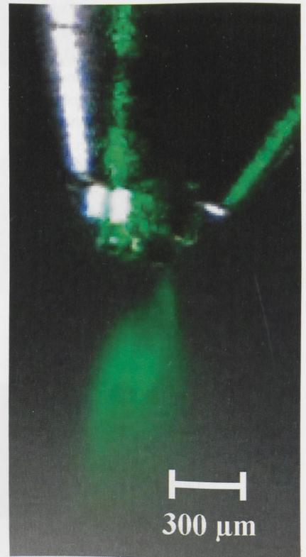
2 *Reale Elektrospray-Ionisation (ESI) zur Kopplung von Kapillarelektrophorese (CE) und Massenspektrometrie (MS)*
