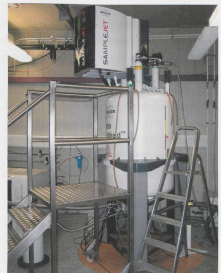
4 600 MHz NMR Spektrometer mit 14.1 Tesla Feldstärke. In der Mitte des Bildes ist das Herzstück des Geräts, der supraleitende Magnet zu sehen. Oben auf dem Magneten befindet sich der automatische Probenwechsler, der bis zu 500 verschiedene Proben aufnehmen kann.
