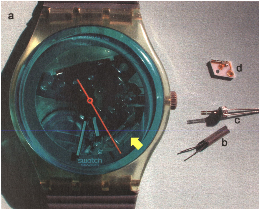
[3] Quarzuhr (a). Der gelbe Pfeil deutet auf einen kleinen evakuierten Metallzylinder (siehe auch b), der das Zeit bestimmende Element der Uhr enthält, eine Quarzstimmgabel (c). Aus dieser Stimmgabel lässt sich ein Federbalken für die Kraftmikroskopie herstellen, der aus einer Quarzstimmgabel hergestellt ist („qPlus Sensor“) (d). In der atomar aufgelösten Kraftmikroskopie kommt heute fast ausschließlich die Frequenzmodulations-Kraftmikroskopie zum Einsatz, wobei die zwischen Spitze und Probe wirkenden Kräfte über die Frequenzverschiebung des schwingenden Federbalkens ermittelt werden. Siliziumfederbalken, wie sie in Abb. 2 gezeigt sind, sind aber keine guten Frequenznormale – ihre Eigenfrequenz ändert sich stark mit der Temperatur. Seit den 70er Jahren kommen deshalb in der Uhrentechnik Quarzstimmgabeln zum Einsatz, die weit präzisere Frequenz- und damit Kraftmessungen ermöglichen.
