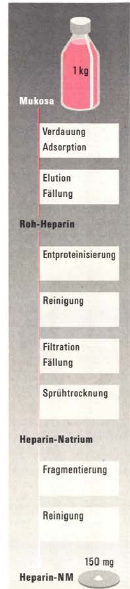
Produktion des Niedermolekularen Heparin aus Schweinedarmmukosa.
