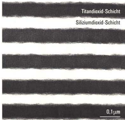
7 Elektronenmikroskopische Transmissionsabbildung des Querschnitts einer optischen (dielektrischen) Viellagenschicht, bestehend aus einer periodischen Folge von amorphem Siliziumdioxid und polykristallinem Titandioxid. Die kristalline Struktur der einzelnen Lagen wird erst bei stärkerer Vergrößerung (hier nicht gezeigt) sichtbar. Von Interesse für die Anwendung ist die erkennbare Rauigkeit der Grenzflächen zwischen den einzelnen Lagen. Die Rauigkeit mindert die Qualität solcher Schichtsysteme.
