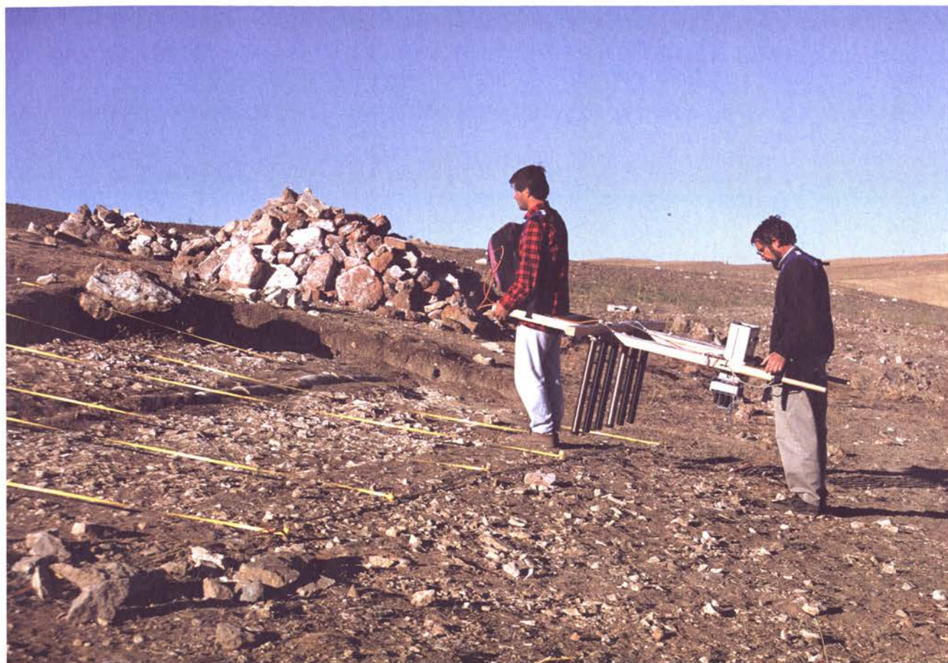
14 Prospektion des ehemaligen Stadtareales von Kuşaklı-Sarissa mit einem Sechsfach-Fluxgate-Gradientensonden-Array des Institutes für Geophysik Kiel. Gemessen wird die Differenz des Magnetisierungsgrades archäologischer Strukturen im Boden zur Stärke des natürlich-magnetischen Erdfeldes. Reste gebrannter Lehmziegelmauern sind beispielsweise als starke positive Anomalien zu erkennen, Kalksteinfundamente als negative Anomalien aufgrund ihrer im Vergleich zum umgebenden Boden geringeren Magnetisierung.
