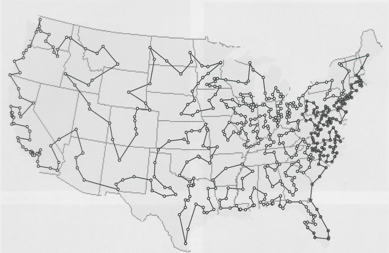
3 Zum Testen von heuristischen Optimierungsverfahren wurden viele Beispiel-Instanzen für verschiedene Problemstellungen in den letzten Jahrzehnten zur Verfügung gestellt. Das Beispiel hier zeigt die optimale Lösung für eine Rundreise durch 532 Orte in den USA. Die Schwierigkeit bei dieser speziellen Aufgabenstellung besteht u. a. darin, dass die Orte an der Ostküste einen viel geringeren Abstand zu ihren nächsten Nachbarn haben als Orte im mittleren Westen.
