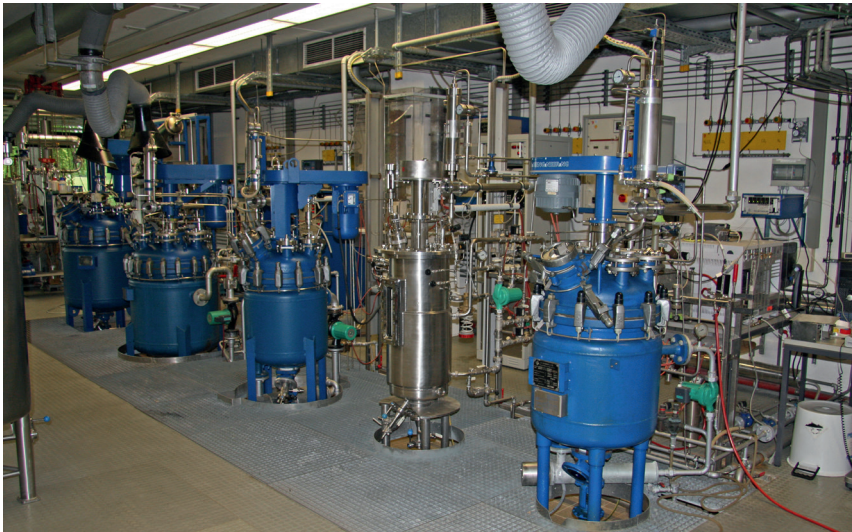
2 Zur Anzucht von Hochtemperaturorganismen stehen im Biotechnikum der Universität Regensburg elf verschiedene Bioreaktoren, sogenannte Fermenter, in unterschiedlichen Größen von 7 bis 300 Liter Fassungsvermögen zur Verfügung.
