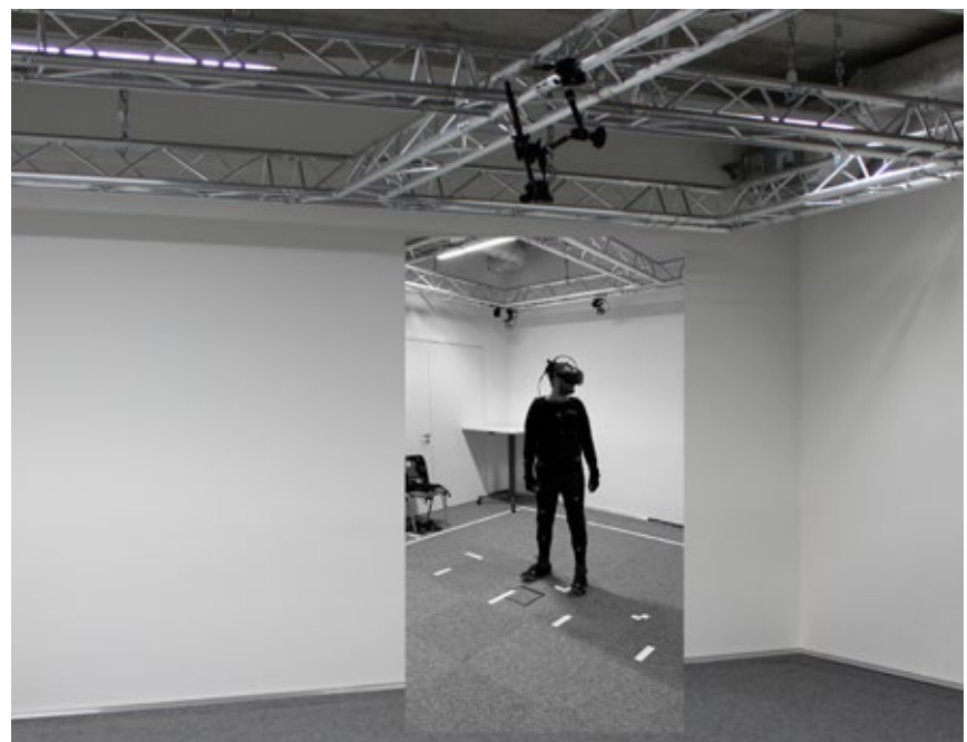
6 VR-Studio in der Tech Base, Kameras des Motion Tracking-Systems sind an den Traversen angebracht; im eingesetzten Bild eine Versuchsperson im Motion Tracking-Anzug und mit VR-Brille
